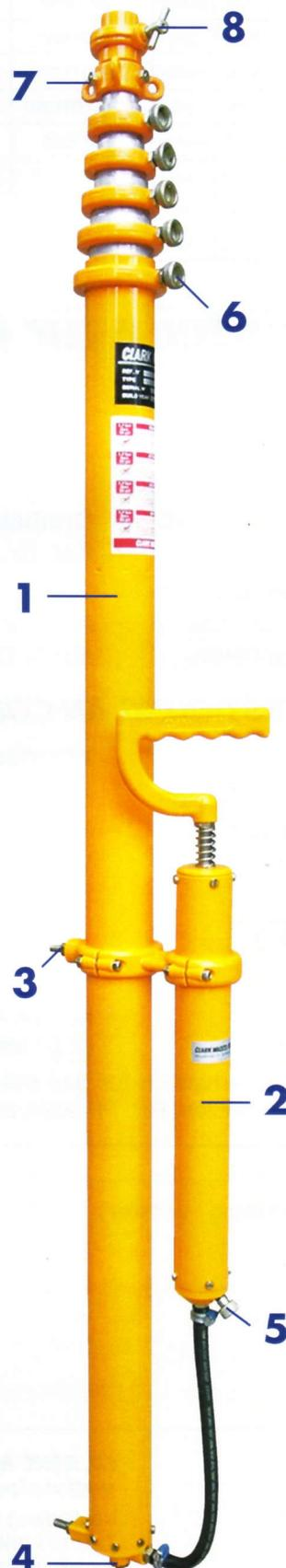
Die seitlich angeflanschte Handpumpe versorgt den Mast mit Druckluft für das Ausfahren und gewährleistet, mittels eines Ventils, das Einfahren. Jede Mastsektion kann mit einer Klemmschraube gesichert werden, sodass der Mast für eine längere Zeitspanne ausgefahren bleibt. Bei aufkommendem Wind kann der Mast am Abspannkragen abgespannt werden.
